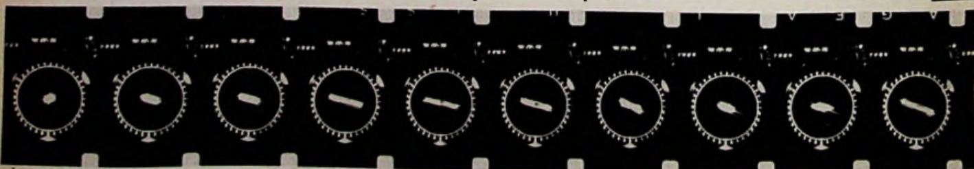
Bild 3. Reihenaufnahme der vom künstlichen Satelliten empfangenen Sendungen. Das Peilgerät erfaßt auch sehr kurzzeitige und sich schnell bewegende Objekte. Dies erfolgt mit einer automatischen Filmkamera, die gleichzeitig Uhrzeit und Aufnahmenummer festhält. Die hier gezeigten Aufnahmen wurden mit etwa Sekunden-Abstand gemacht. Man erkennt innerhalb der dargestellten 10 Sekunden bereits eine leichte Rechtsdrehung des
