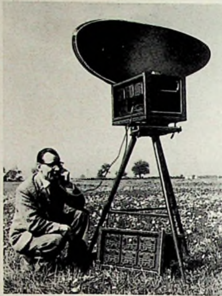
7-GHz-Kleinfunkbrücke im Einsatz. Oben H-Gerät mit Sender, Empfänger, Dipolantenne und Hohlspiegelreflektor, unten M-Gerät mit maximal sechs Modulatoren, Meßverstärker, Meßfeld, Fernsprechan-schlüssen und Netzeil
